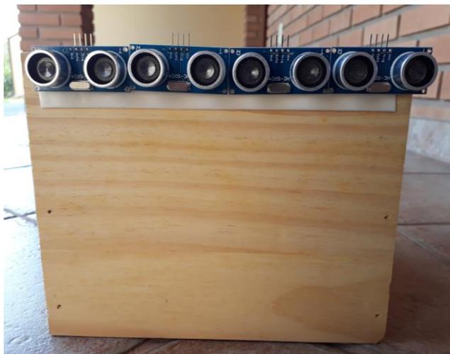
Figura 14: superfície onde os sensores ultrassônicos foram dispostos para teste.
