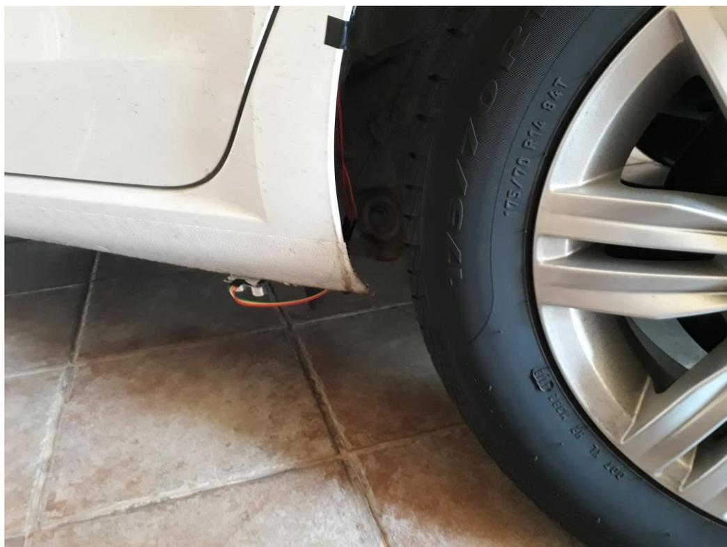
Figura 17: sensor de distancia localizado logo a frente da roda traseira do lado do passageiro durante a calibração da escala de lotação com 4 passageiros.
