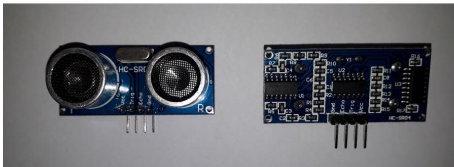
Figura 5: vistas superior e inferior do sensor HC-SR04.
