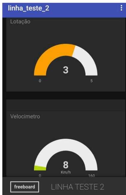
Figura 30: lotação e velocidade do veículo no primeiro ponto de captura de tela do aplicativo, durante o teste da segunda rota.
