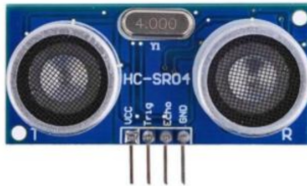
Figura 9. Módulo Sensor de Distância Ultrassônico HC-SR04
