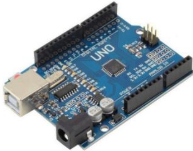
Figura 12. Placa Arduino UNO
