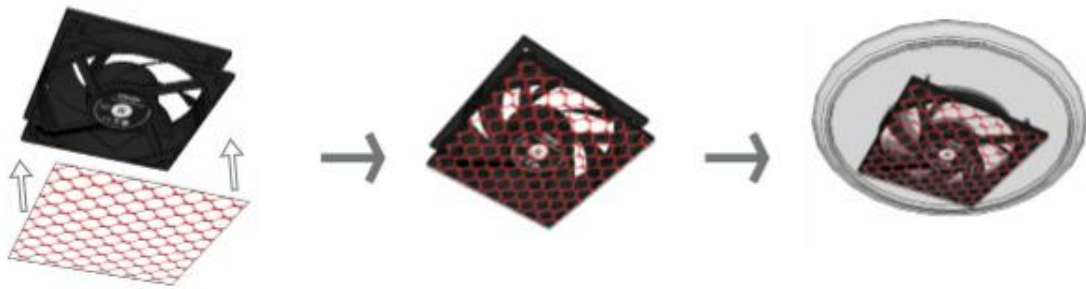
Figura 128. Fixação do Cooler na Tampa do Cilindro
