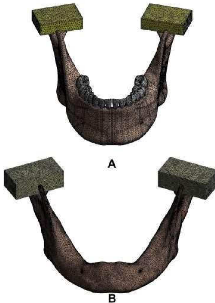
Figura 2. A) Malha de elementos finitos tetraédrica da mandíbula humana dentada obtido no software Ansys v14 (Ansys, Inc.) B) Malha de elementos finitos tetraédrica da mandíbula humana desdentada obtido no software Ansys v14 (Ansys, Inc.)
