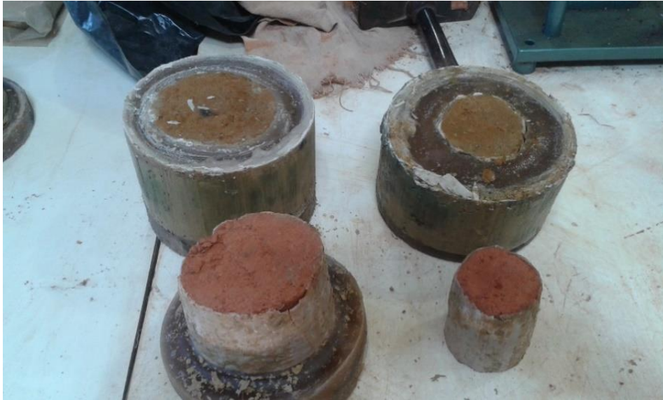
Figura 23 - Foto dos corpos de prova moldados na vertical e horizontal após o ensaio de permeabilidade
