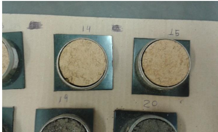
Figura 86 - Corpos de prova mostrando o quanto o solo contraiu durante a realização do procedimento das curvas de retenção
