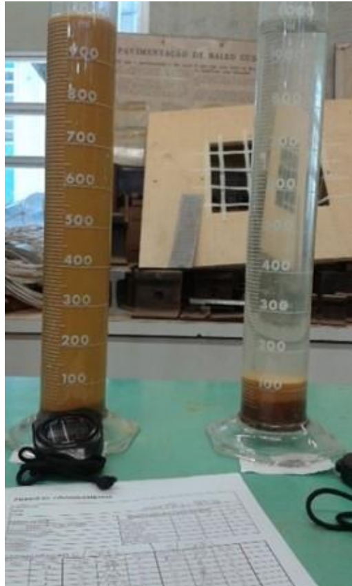
Figura 18 - Foto do processo de sedimentação para o horizonte B2 da trincheira TR1
