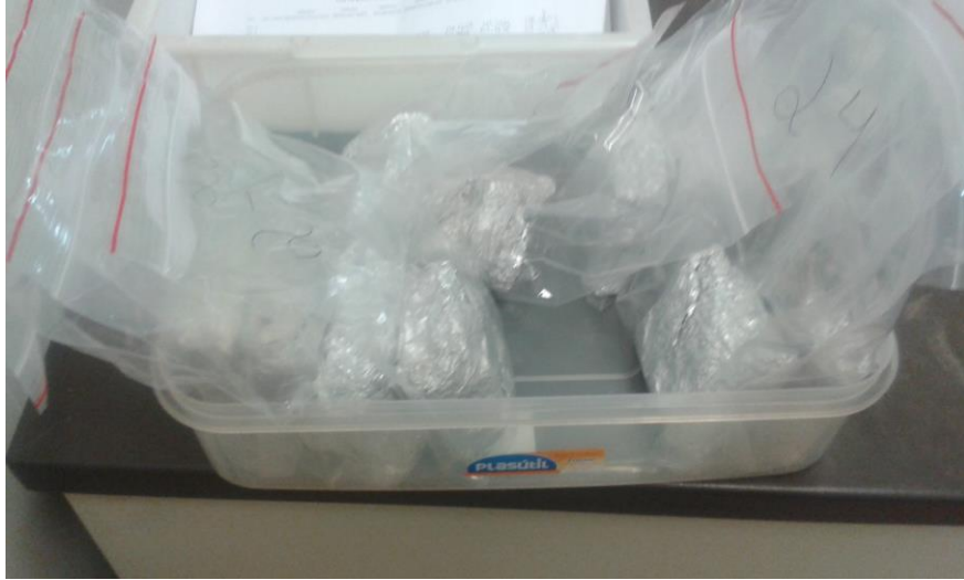
Figura 20 - Acomodação das amostras no ensaio de curva de retenção a água com o método do papel filtro
