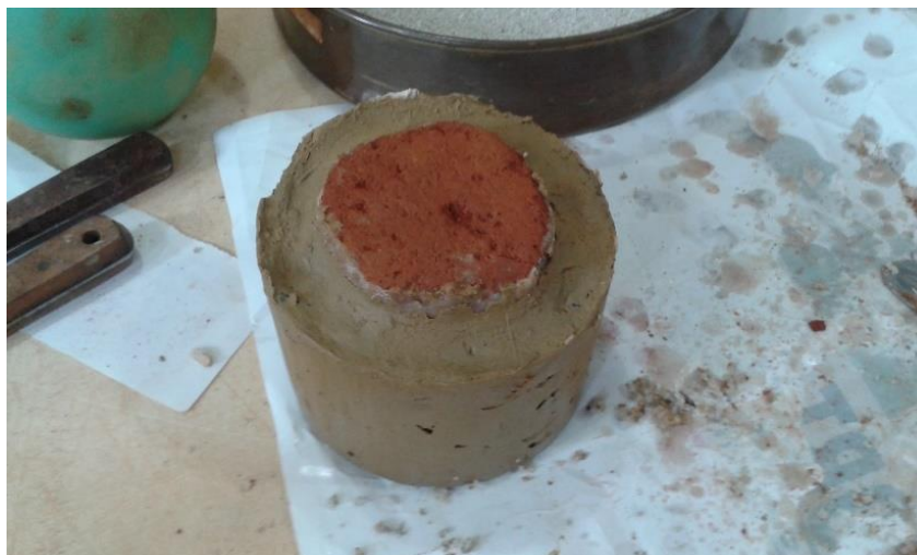
Figura 36 - Corpo de prova do ensaio de condutividade hidráulica do horizonte B da TR9
