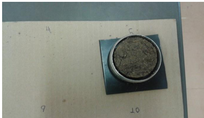
Figura 41 - Foto de um anel do horizonte A da TR3, utilizado para a curva de umedecimento
