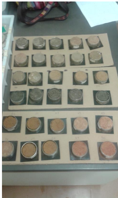
Figura 21 - Anéis volumétricos usados para o ensaio da curva de retenção tendo uma geomembrana na base para apoiar as amostras
