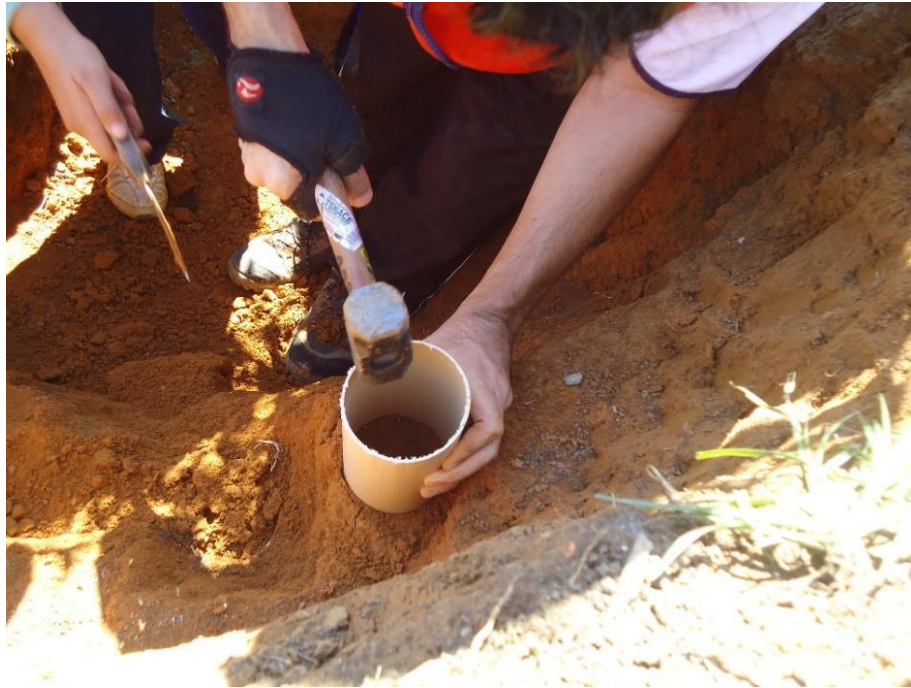
Figura 17 - Foto das amostras indeformadas, sendo retiradas no campo para os ensaios de permeabilidade e resistência ao cisalhamento
