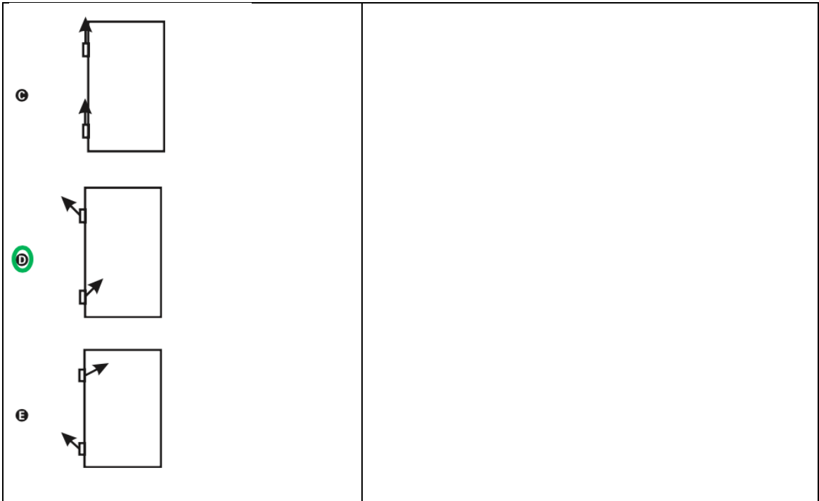
Figura 45: Decomposição das forças na dobradiça da porta. Fonte: Elaborado
