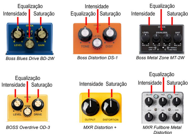
Figura 67: Controles de saturação, intensidade e equalização presentes em pedais de guitarra.
