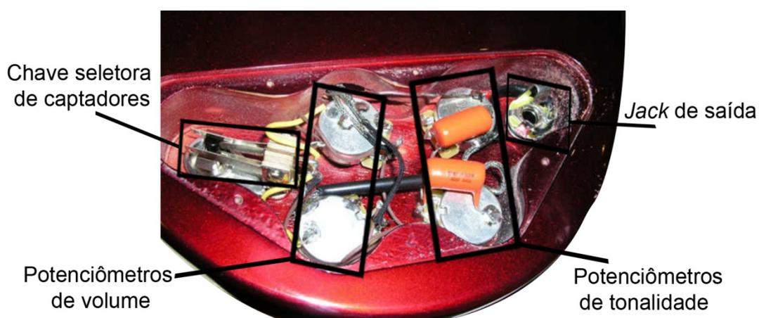
Figura 5: Imagem detalhada dos componentes elétricos na parte de trás da guitarra *Gibson SG Special 2017 T – Cherry*.
