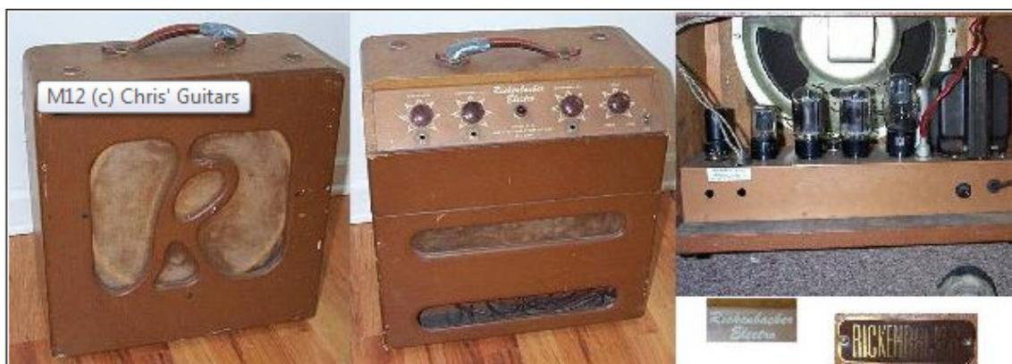
Figura 52: Amplificador combo modelo M12 de 1933 da Rickenbacker Electro.
