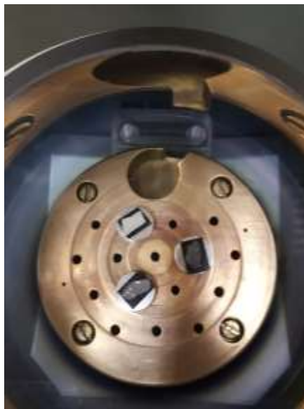
Figura 14 – Preparação das amostras com metalização com filme de ouro para realização de MEV
