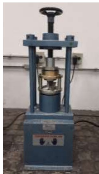
Figura 13 – Ensaio de resistência à compressão simples
