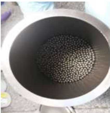
Figura 3 - Cilindro e esferas de aço inox
