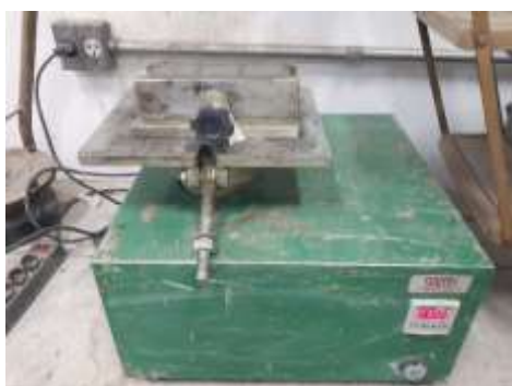
Figura 8 - Mesa automática de adensamento.
