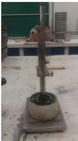
Figura 7 – Aparelho de Vicat para determinação da consistência normal das pastas utilizando a sonda de Tetmajer
