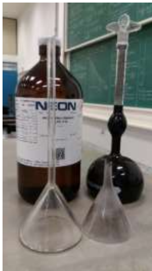
Figura 5 - Frasco de Le Chatelier para determinação da massa específica das amostras.
