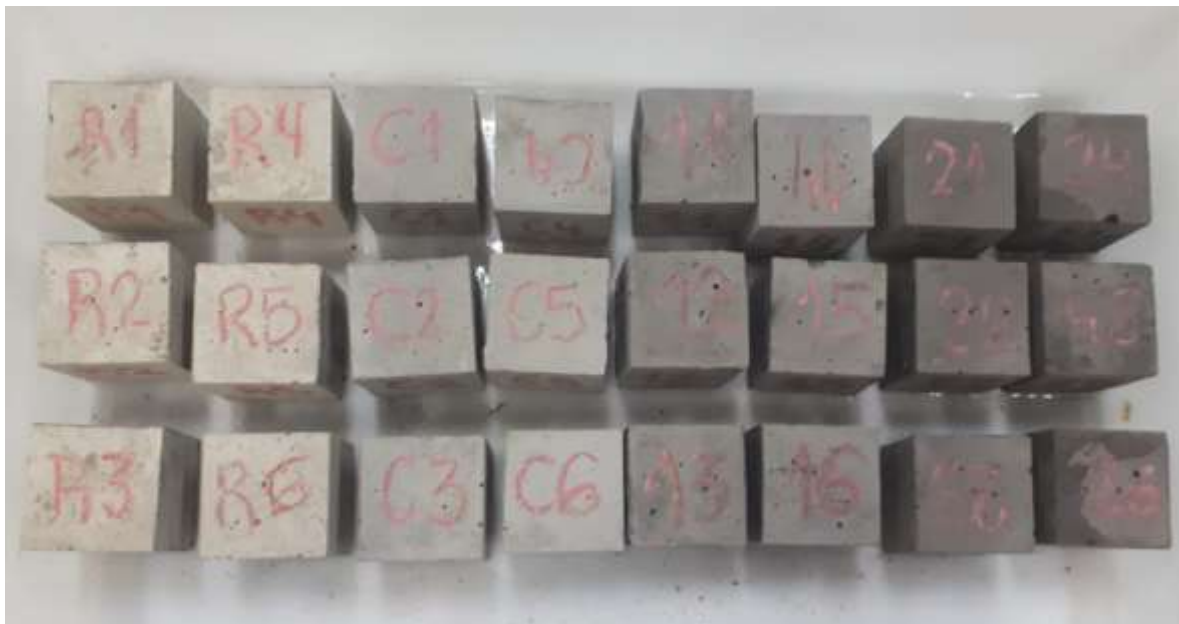
Figura 10 – Corpos de prova cúbicos de pastas referência e com biochar de bagaço de cana de açúcar.
