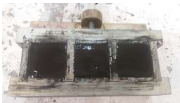
Figura 9 - Molde cúbico utilizado na fabricação dos corpos de prova
