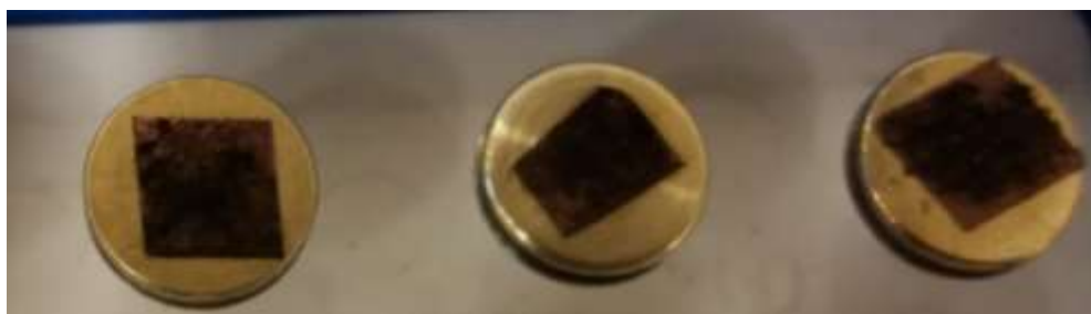
Figura 6 - Amostras de biochar para análise de microscopia.
