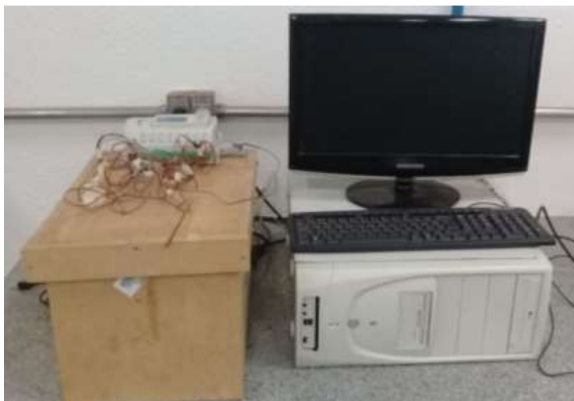
Figura 11 - Equipamento FieldLogger para aquisição de dados de calorimetria.
