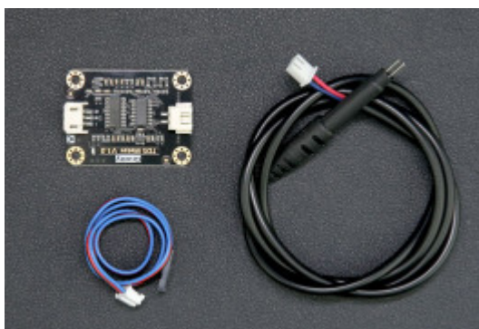
Figura 3.6: Os componentes do sensor de SDT e CE (DFROBOT, Acesso em 08 de Maio de 2018).
