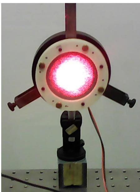
Figura 5.3: Membrana pintada com tinta retrorefletora fixa a um alto-falante.
