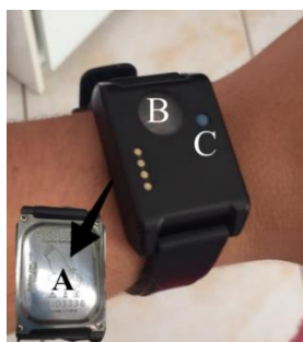
Figura 2 – Sensores do actígrafo: temperatura (A), luxímetro (B) e botão marcador de evento (C).
