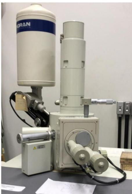
Figura 5. Microscópio Eletrônico de Varredura (MEV).
