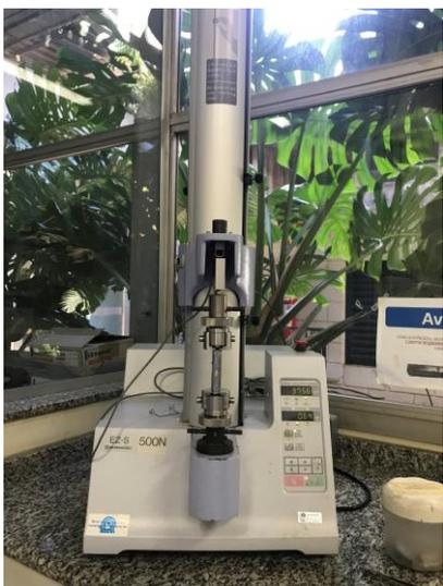
Figura 3. Teste de Microtração.
