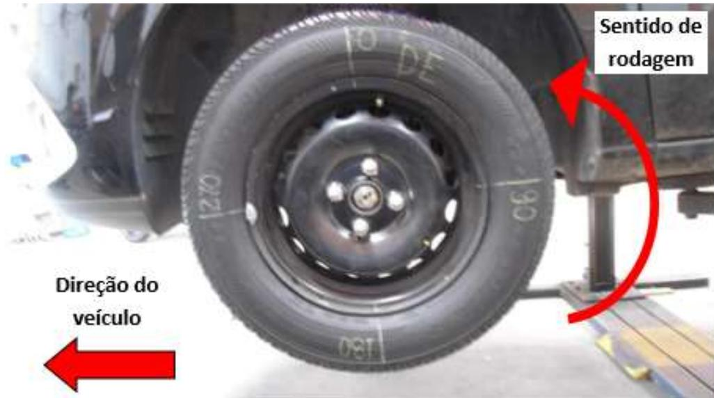
Figura 18: Medição do pneu realizada a cada 90 graus (Arquivo pessoal).
