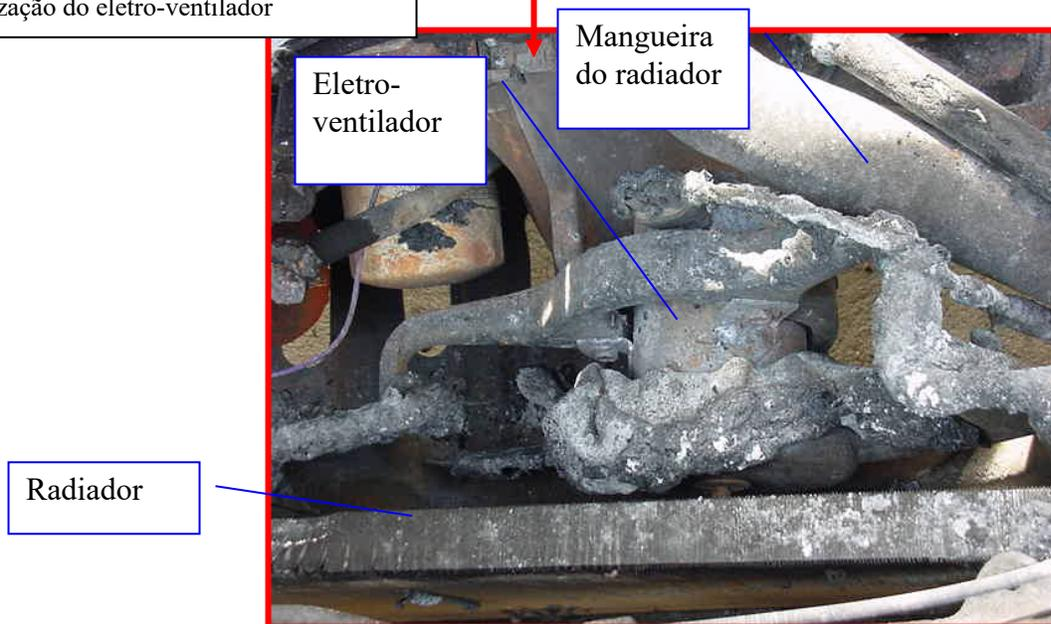
Fig. 10: Pontos carbonizados no eletro-ventilador
