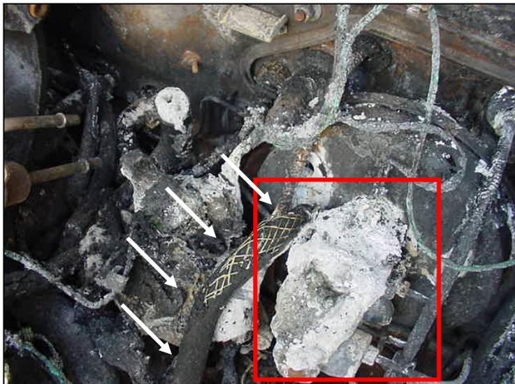
Fig. 17: Reservatório de fluido de freio parcialmente fundido
