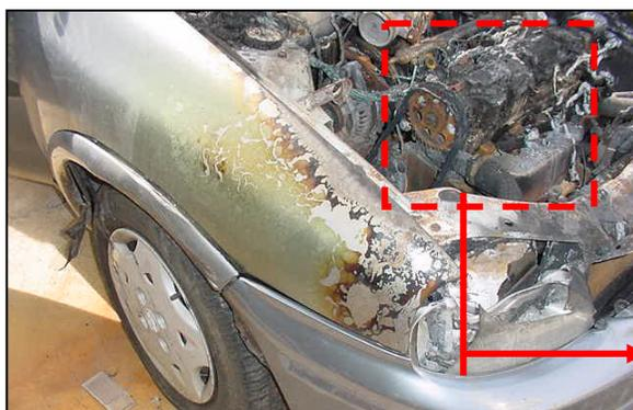
Fig. 6: Pontos carbonizados no compartimento do motor
