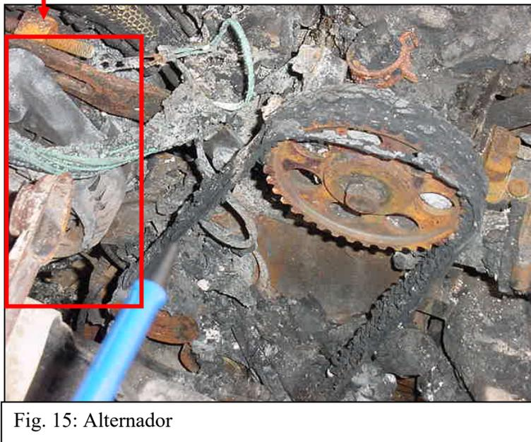
Com o provável vazamento de combustível apresentado em uma das extremidades da flauta (Fig. 12), foi constatado que o mesmo deve ter tido sua combustão iniciada após ter caído e entrado em contato com o alternador (Fig. 14 e 15), que em funcionamento gera muitas faíscas e diante disso temos completos os pontos
