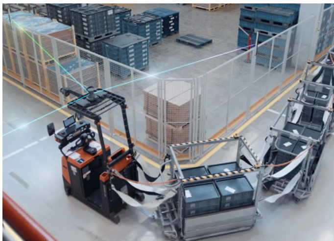
Figura 4.9 Logística: Sensores - sistemas de transporte sem motorista (Fonte: BOSCH, c2021).
