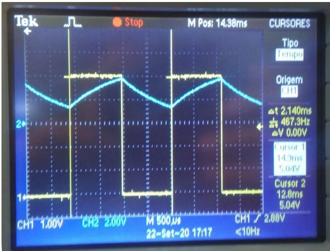
Figura 5.6 – Formas de onda del oscilador.
