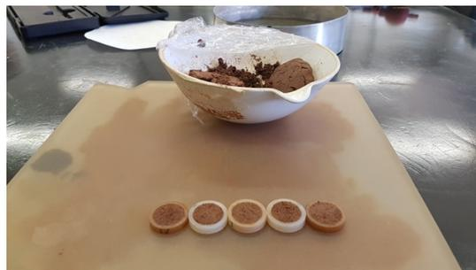
Figura 4.6 - Preenchimento dos anéis de PVC
