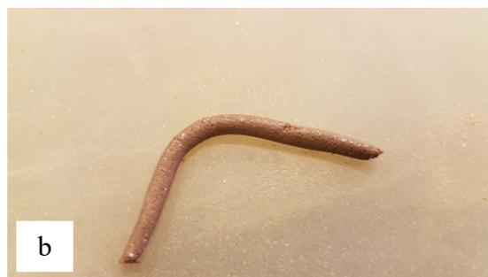
Figura 4.7 – Cilindros usados para determinação da plasticidade da amostra
