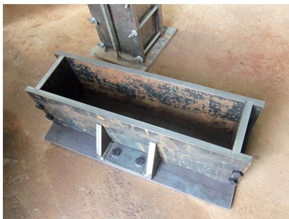
Figura 4.14 - Forma utilizada para moldagem das amostras
