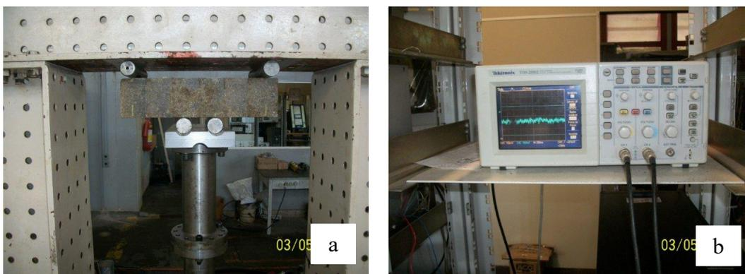
Figura 4.17 – Equipamento e acessórios para determinação da vida de fadiga
