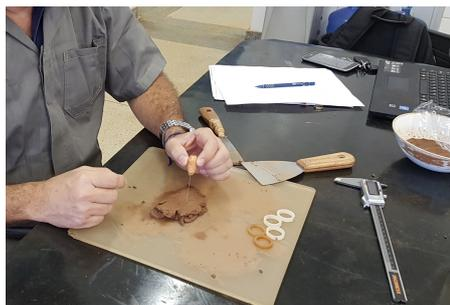
Figura 4.5 - Verificação da consistência da amostra usando minipenetrômetro manual
