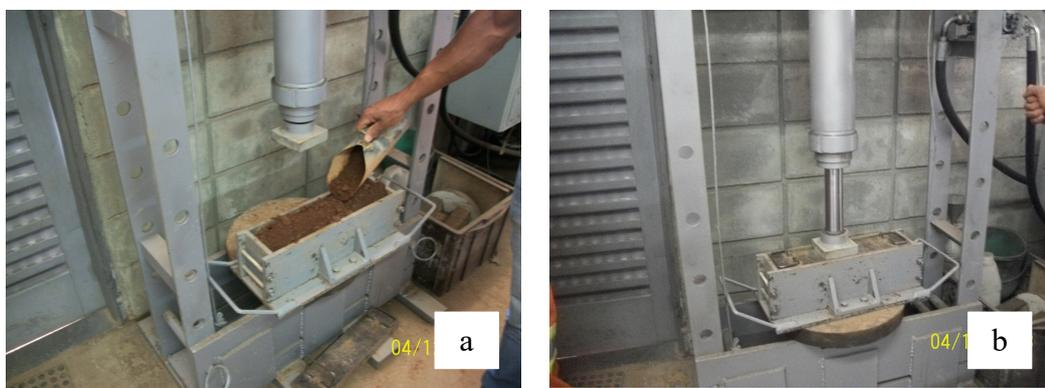
Figura 4.15 - Prensagem dos corpos de prova
