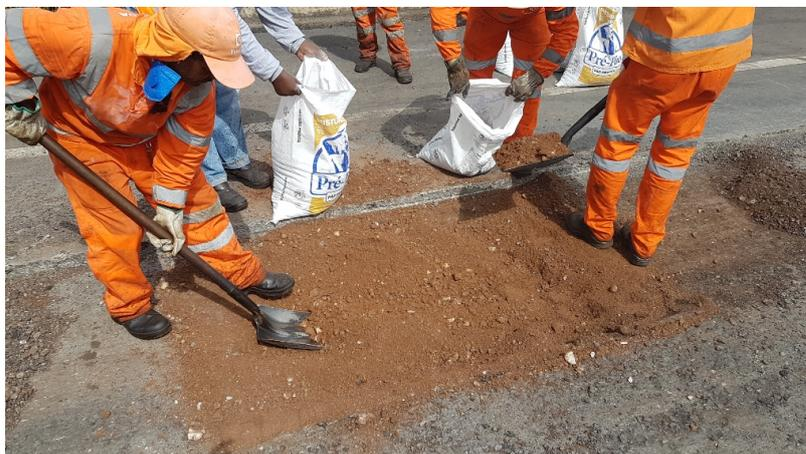
Figura 3.6 – Extração da amostra da base de cascalho laterítico
