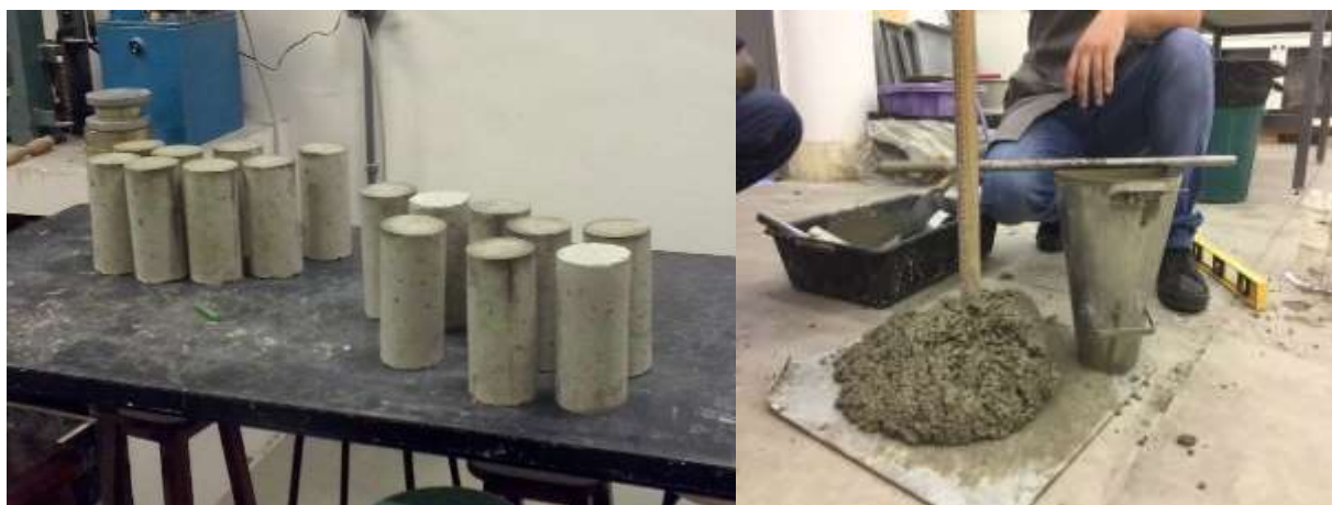
Figura 26 – Detalhe dos testemunhos de concreto obtidos Fonte: O Autor (2021).
