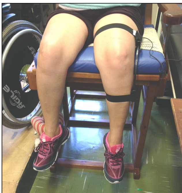
Figura 8. Voluntário posicionado em cadeira de altura elevada para realização do teste do pêndulo, associado ao dispositivo do eletrogoniômetro em coxa esquerda, afixado por duas tiras elásticas com velcro. Fonte: Arquivo Pessoal.
