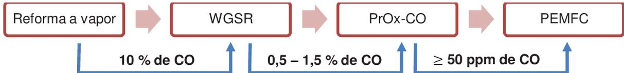
**Figura 3:** Representação dos processos de obtenção e purificação do gás hidrogênio.<sup>10</sup>
