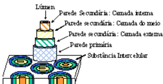
Fig. 2. Representação esquemática da estrutura das fibras vegetais [28].
