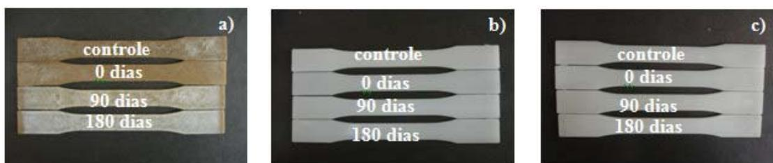
**Fig. 58.** Fotografias comparativas das amostras: **(a)** PEAD/20FC/2PEAM; **(b)** PEAD/2PEAM; **(c)** PEAD; após 0, 90 e 180 dias de envelhecimento e das amostras controle.
