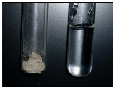
Figura 18. NaCl (esquerda; p.f. 800 °C) e [BMIM][PF 6 ] (direita; T g -61 °C).
