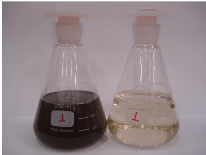
**Figura 63** – Tratamento de  $200 \text{ cm}^3$  de efluente 1, empregando-se 500 mg de Fil-COTA, sem o ajuste de pH e tempo de contato de 6 h, sob agitação, sendo o Fil-COTA ( — ) e o efluente bruto ( — ). A foto ilustra a coloração do efluente bruto à esquerda e do efluente tratado à direita.
