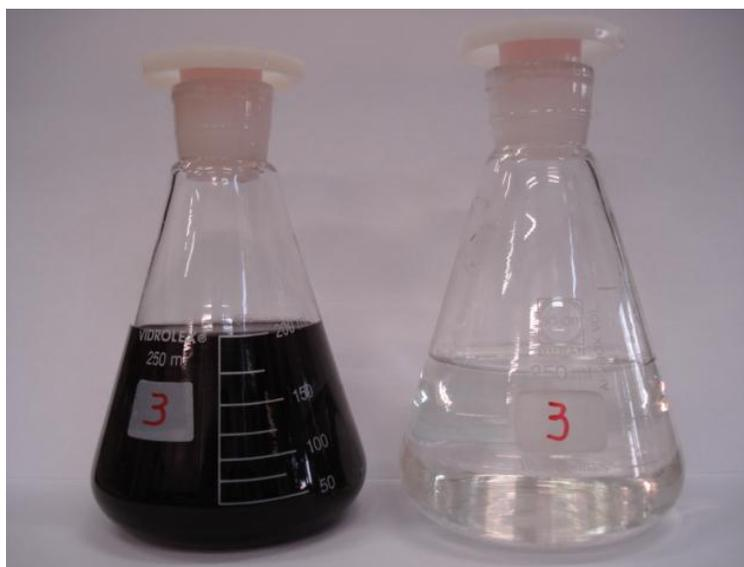
**Figura 65** – Tratamento de  $200 \text{ cm}^3$  de efluente 3, empregando-se 500 mg de Fil-COTA, sem o ajuste de pH e tempo de contato de 6 h, sob agitação, sendo o Fil-COTA ( — ) e o efluente bruto ( — ). A foto ilustra a coloração do efluente bruto à esquerda e do efluente tratado à direita.
