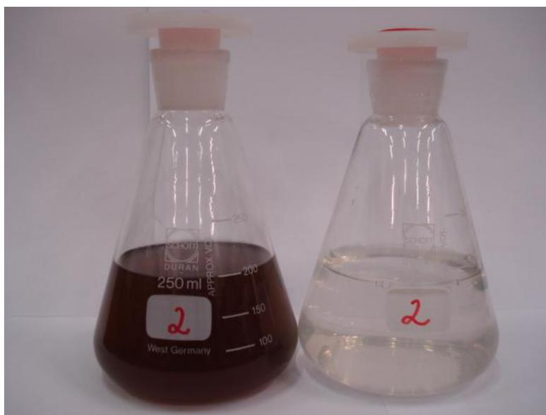
**Figura 64** – Tratamento de 200 cm<sup>3</sup> de efluente 2, empregando-se 500 mg de Fil-COTA, sem o ajuste de pH e tempo de contato de 6 h, sob agitação, sendo o Fil-COTA ( — ) e o efluente bruto ( — ). A foto ilustra a coloração do efluente bruto à esquerda e do efluente tratado à direita.
