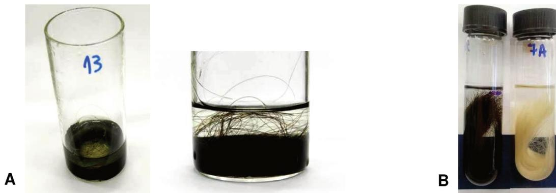
Figura 26: Fotografias mostrando os cabelos imersos em solução de tensoativo. (A) tubo de 4,0 cm de diâmetro e 10,0 cm de altura, (B) tubo de 2,5 cm de diâmetro e 10,0 cm de altura com tampa rosqueável. Na foto B foi colocada uma faixa de fundo escuro para facilitar a visualização.
