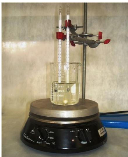
Figura 10: Aquecimento da água para medidas de temperaturas utilizando um termômetro sem proteção e outro com proteção de silicone.
