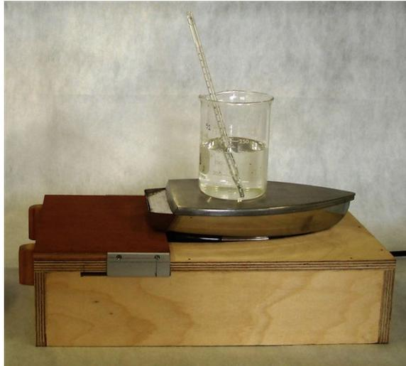
Figura 5: Ferro Elétrico adaptado como Chapa de Aquecimento.
