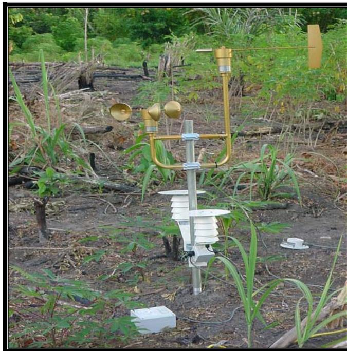
**Figura 5.1:** Estação meteorológica compacta em campo.
