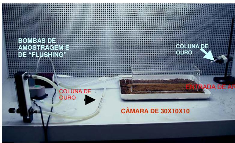
**Figura 3.3:** Montagem da câmara de fluxo de 30x10x10 cm, conectada às bombas de sucção e ao rotâmetro, dentro da capela de fluxo. Estudo da influência da vazão sobre a emissão de Hg<sup>0</sup> pelos solos.
