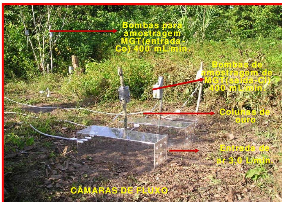
**Figura 4.3:** Medida de fluxos de Hg<sup>0</sup> no campo utilizando as câmaras dinâmicas de fluxo.
