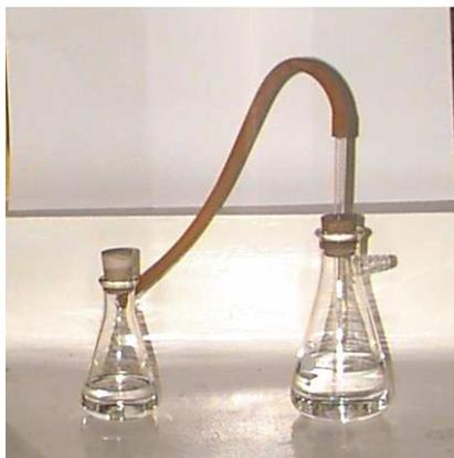
Figura 4.2: Sistema utilizado para estudo da perda de acetonitrila por evaporação.
