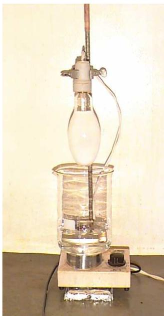
Figura 4.3: Sistema utilizado para degradação de 1L de resíduo contendo 20% de acetonitrila sob irradiação de lâmpada de luz mista (vapor de mercúrio e filamento de tungstênio).
