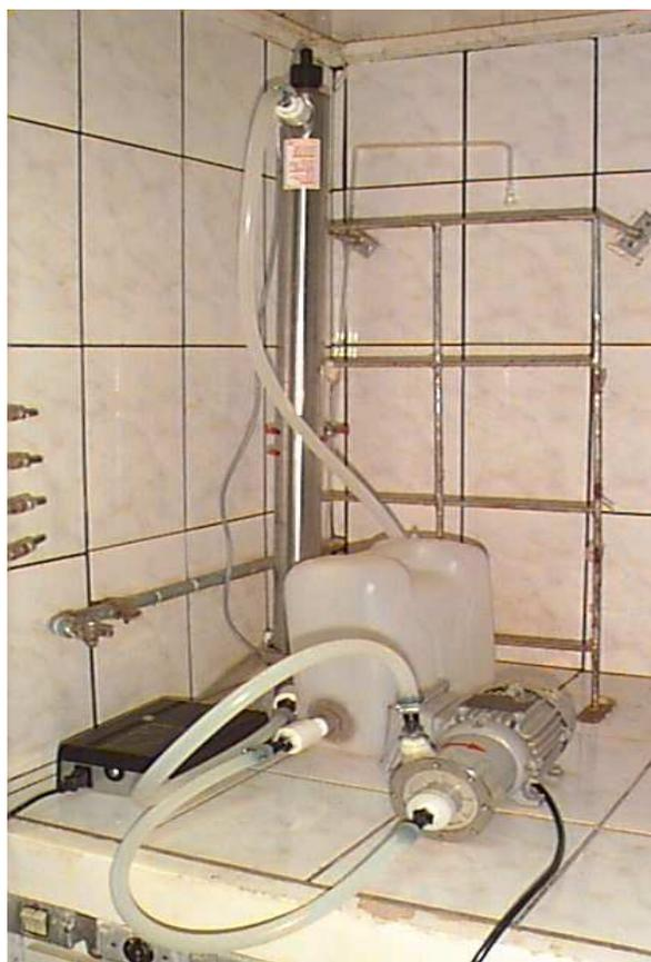
Figura 4.1: Reator químico utilizado para degradação de acetonitrila
