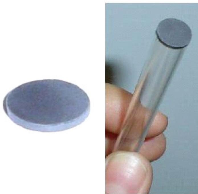
Figura 5a): Imagem do eletrodo de disco rígido prensado.
