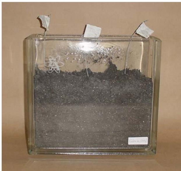
**Figura 12.** Cuba utilizada para o teste de biodegradação em solo.
