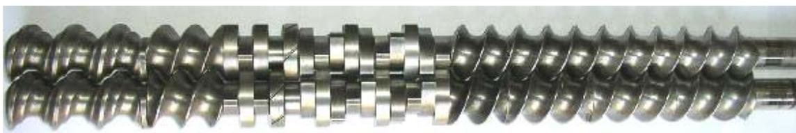
**Figura 11.** Roscas utilizadas para a obtenção dos compósitos PHBV/PHBV-g-AM/Lignosulfonato.
