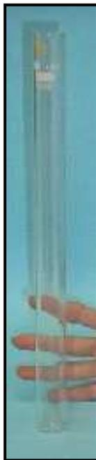
**Figura 1.** Tubo de vidro de Nessler utilizado no método ASTM D 1209-00.
