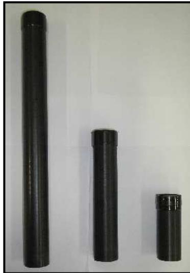
**Figura 12.** Celas de medida confeccionadas com tubo de PVC preto rígido de 12,5 mm de diâmetro.
