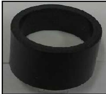
**Figura 14.** Tampa inferior, contendo uma placa de Teflon branco como superfície refletora difusa.
