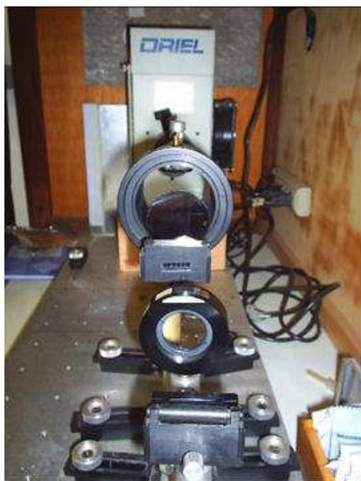
Figura 4.1. Imagem do banco óptico evidenciando o compartimento que continha a lâmpada Xe(Hg) 250 W Oriel, filtros e a lente colimadora.
