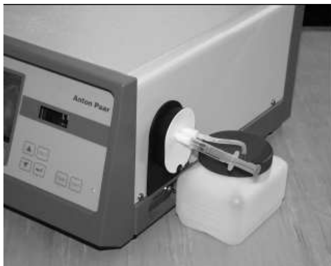
Figura 2: Densímetro Anton Paar, DMA 4500, vista lateral, durante o procedimento de injeção da amostra [11] .
