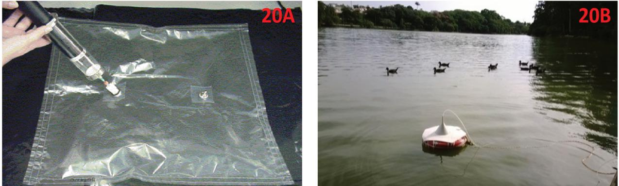
**Figura 20-** Exemplos de coleta de amostras de ar atmosférico em diferentes matrizes ambientais. Na Figura **20A**, exemplo de coleta de amostras discretas de ar externo ao laboratório. Na Figura **20B**, flutuador utilizado para coleta do ar atmosférico na interface ar/água.
