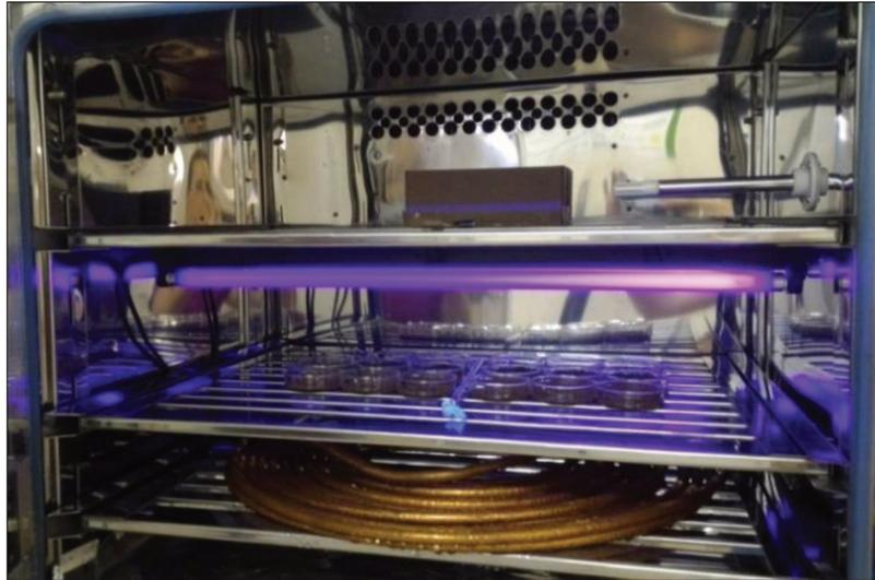
**Figura 15.** Foto da câmara climática com o trocador de calor e as lâmpadas fixadas na prateleira superior.
