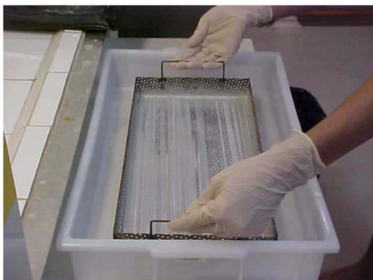
**FIGURA 10:** Procedimento de recobrimento dos tubos de quartzo com o filme de  $\text{TiO}_2/\text{ZrO}_2$
