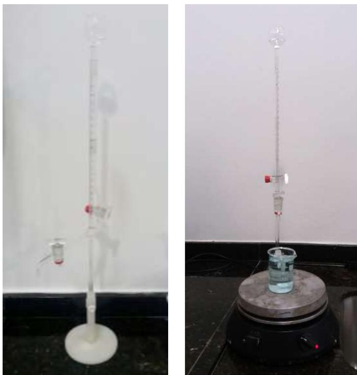
**Figura 8: Bureta de vidro de 2 mL tipo ‘student’ e agitador magnético.**
