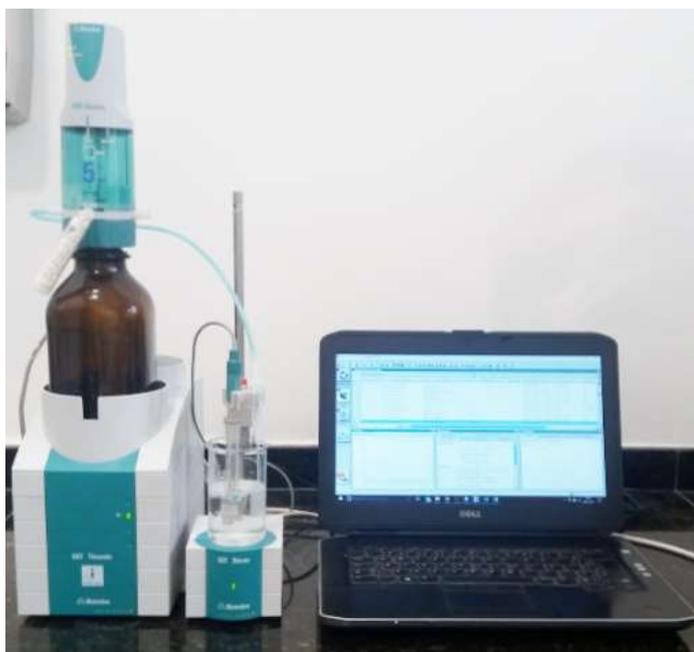
**Figura 9: Titulador potenciométrico automático Metrohm Titrand 905.**
