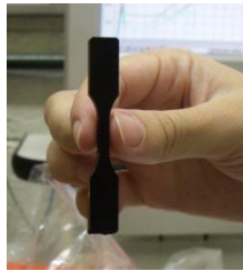
Figura 21 - Corpo de Prova de ensaio de tração (ASTM D-638 – tipo I) do compósito 15FC-PAni(APTS) processado em mini-extrusora e injetado via moldagem por transferência.
