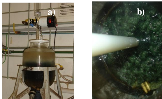
Figura 8 - a) Reator utilizado na síntese da polianilina na presença da fibra, b) interior do reator mostrando a fibra de curauá modificada com PAni.
