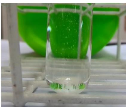
**Figura complementar C.1.a.** Teste de desprendimento de gás carbônico realizado com o ácido benzóico (**23**) utilizando uma solução aquosa de  $\text{NaHCO}_3$  a 5%.
