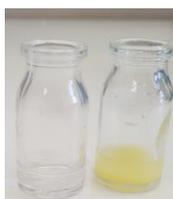
**Figura complementar I.1.d.** Complexação do ácido oxálico (36) com íons  $\text{Fe}^{2+}$ .
