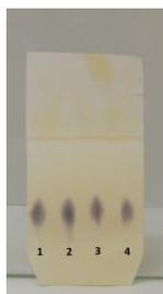
**Figura complementar B.1.c.** Cromatograma obtido após a revelação da “placa” contendo a vitamina C (1) utilizada como padrão e as amostras das polpas de caju (2), goiaba (3) e acerola (4). Solvente de desenvolvimento: etanol combustível/água (5:1).
