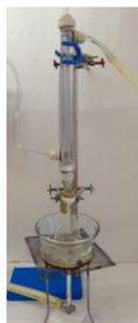
**Figura 26.** Sistema de refluxo para hidrólise do paracetamol em meio ácido.
