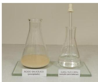
**Figura complementar E.1.c.** Precipitação do ácido salicílico (**15**) com ácido sulfúrico ~ 20% (solução para bateria).
