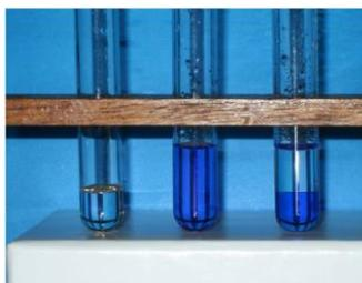
**Figura complementar A.1.b.** Resultados dos testes de solubilidade da glicerina **(2)** em água **(5)** e no removedor **(8)**, com gotas de solução de violeta genciana.
