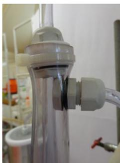
**Figura complementar H.5.b.** Detalhes do condensador de refluxo alternativo.
