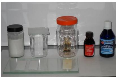
**Figura 13a.** Materiais utilizados na confecção, no desenvolvimento e na revelação das placas de cromatografia em camada delgada.
