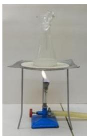
**Figura complementar E.1.b.** “Sistema de refluxo”
