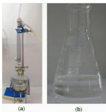
**Figura complementar F.3.b.** a) Sistema de refluxo utilizado para obtenção do benzoato de etila (30); b) Fase oleosa superior, observada na mistura reacional fria.
