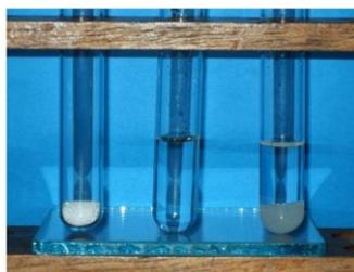
**Figura complementar A.1.a.** Resultados dos testes de solubilidade do açúcar **(1)** em água **(5)** e no removedor **(8)**.
