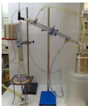
**Figura 37.** Sistema de destilação.
