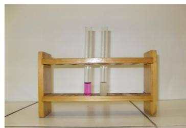
**Figura complementar D.2.e.** Resultado da reação do acessulfame (26) com solução de tintura de iodo.
