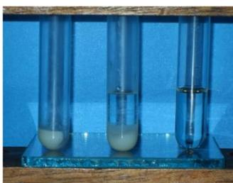
**Figura complementar A.1.c.** Resultados dos testes de solubilidade da gordura vegetal hidrogenada (4B) em água (5) e no removedor (8).
