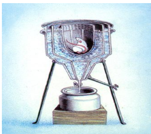
Figura 7. Imagem representando o primeiro calorímetro de gelo, desenvolvido por Lavoisier e Laplace (LAVOISIER, 1783).
