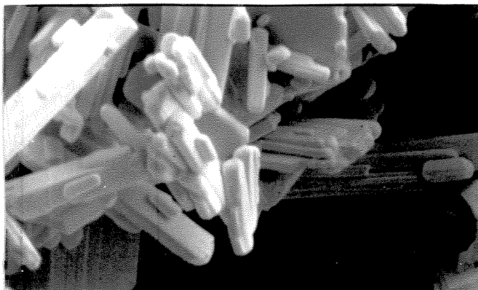
Figura 3.5.5 Micrografia eletrônica de varredura do praziquantel, aumento de 2500 vezes.
