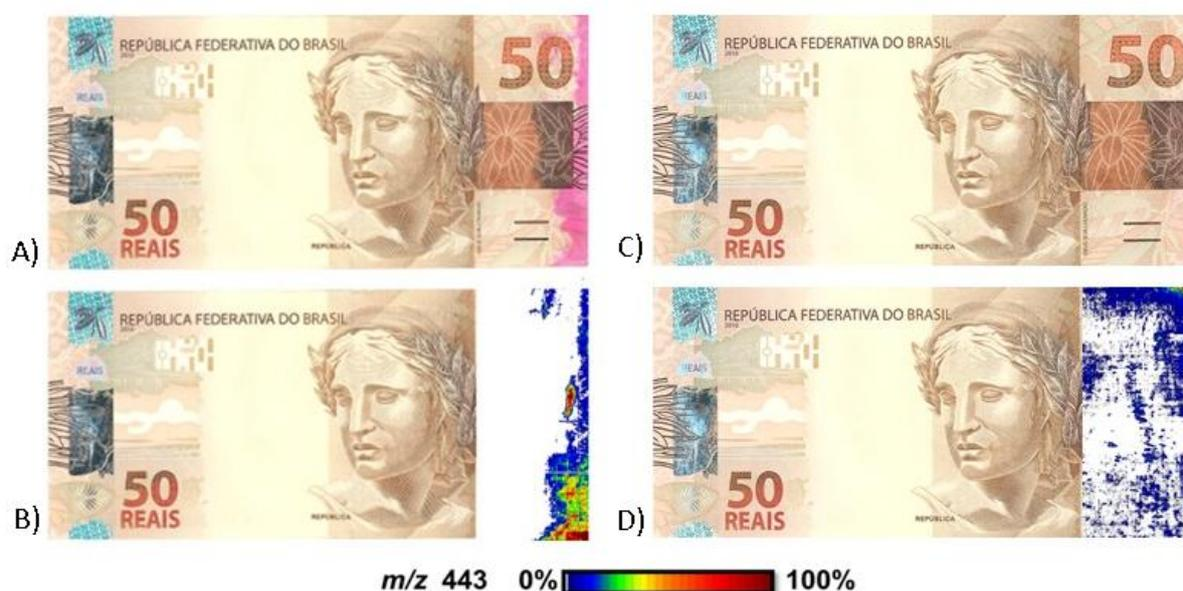
**Figura 35.** (A) Cédula real; (B) cédula contaminada com dispositivo antifurto; (C) resultados DESI-MSI da simulação; (D) cédula lavada e (E) DESI-MSI da cédula lavada.
