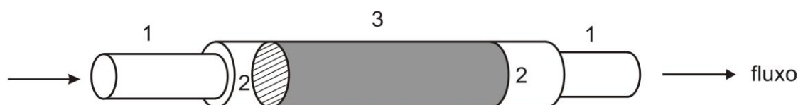
Figura 29. Figura do reator enzimático empregado com a enzima imobilizada em esferas de vidro: 1- Tubo de tygon; 2- Lã de vidro; 3- Tubo de tygon com esferas de vidro com a enzima imobilizada.
