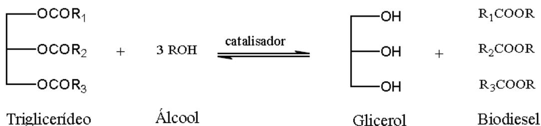
**Figura 1.** Equação genérica que representa o processo de transesterificação de ácidos graxos. R corresponde ao grupo alquil. R<sub>1</sub>, R<sub>2</sub>, R<sub>3</sub>, representam cadeias de ácidos graxos.
