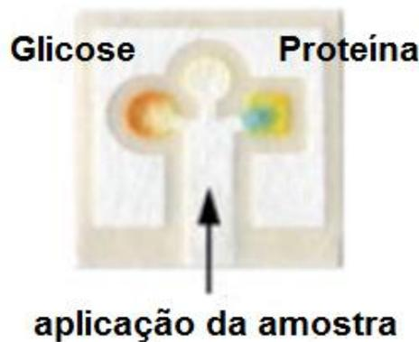
**Figura 3:** Esquema de  $\mu$ PAD confeccionado pela técnica de fotolitografia para detecção simultânea de glicose e proteína em amostra de urina. Fonte: MARTINEZ et al, 2007.
