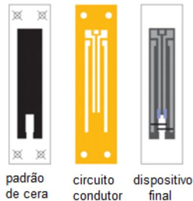
**Figura 5:** Esquema simplificado de  $\mu$ PAD confeccionado com cera sólida associado com detecção eletroquímica para aplicação em monitoramento de glicose. Fonte: GONÇALVES, 2014.
