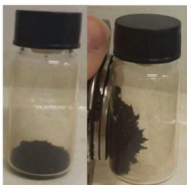
**Figura 15.** Fotografias do nanomaterial sintetizado na ausência e na presença de um ímã.
