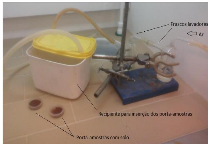
**Figura 20.** Imagem do sistema empregado para se realizar a incubação de amostras de solo com o nicosulfuron.
