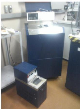
**Figura 14.** Imagem do microcalorímetro isotérmico *TAM 2277*.
