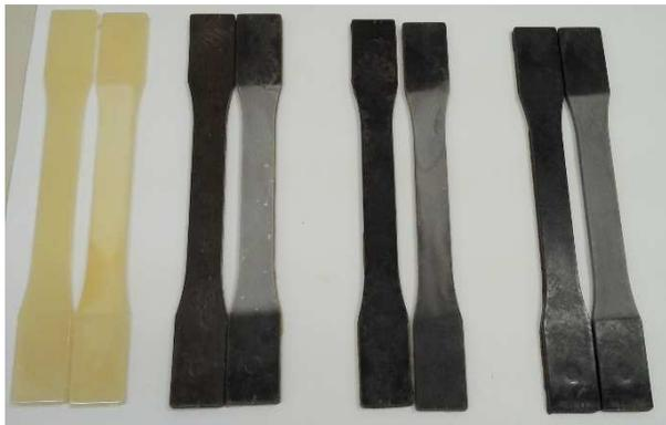
Figura 49: Comparação entre os corpos de prova antes e após o ensaio de envelhecimento acelerado.
