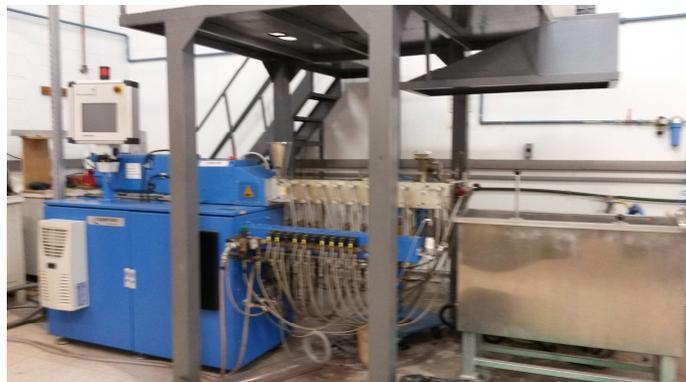
Figura 13: Extrusora dupla-rosca co-rotante interpenetrante (Coperion Werner-Pfleiderer, modelo ZSK-26 Mc).
