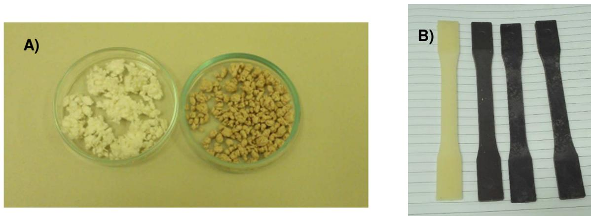
Figura 43: A) Comparação visual entre FB (esquerda) e SB2, B) corpos de prova das formulações (da esquerda para a direita) PA6EBS, PA630FB, PA630SB1 e PA630SB2.
