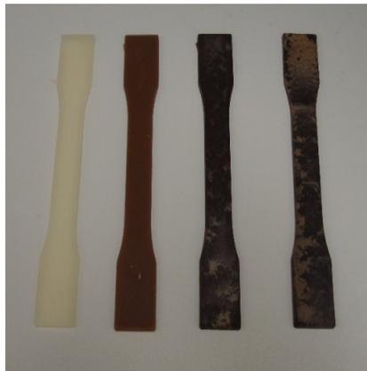
Figura 26: Corpos de prova de tração moldados por injeção. Da esquerda para direita: PA6EBS, PA620FB, PA630FB e PA640FB.
