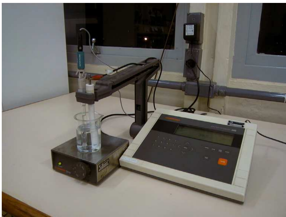
Figura 11: Foto que ilustra o tipo de equipamento utilizado após a preparação do eletrodo: ponteiras, potenciômetro, eletrodo íon-seletivo e eletrodo de referência de Ag/AgCl.
