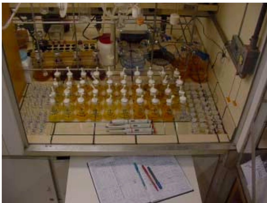
Figura 30 - Bateria de biooxidações simultâneas LMS/TV por planejamento fatorial
