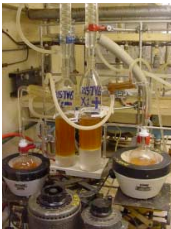
Figura 32 - Foto de extração de bioxidação em extrator contínuo
