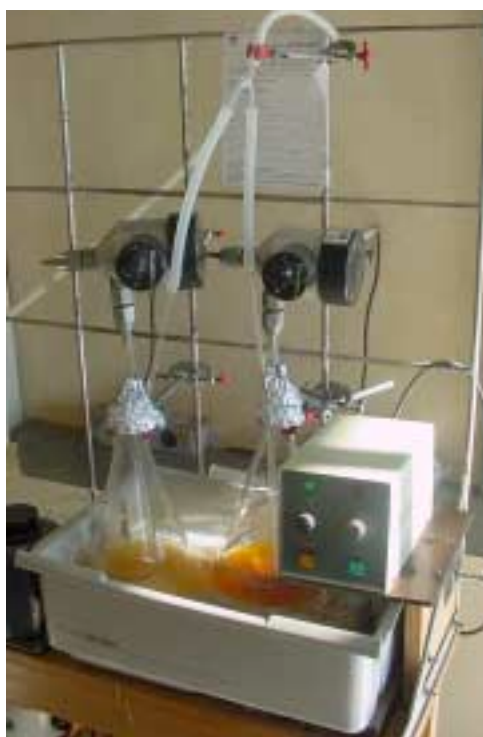
Figura 29 - Foto de biooxidações LMS/TvL sob agitação mecânica, com aeração de ar comprimido, pressão atmosférica e com temperatura controlada em banho maria
