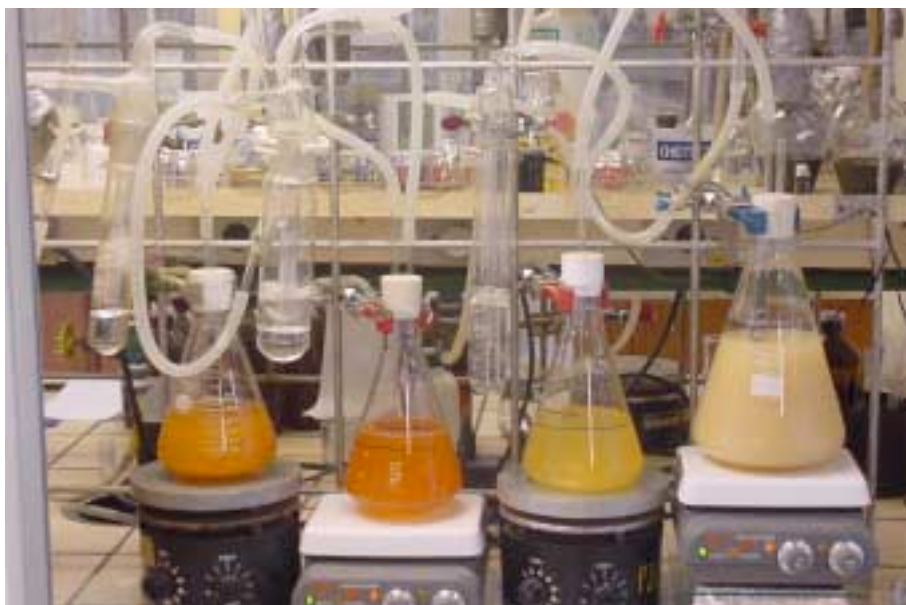
Figura 28 - Foto de Biooxidações LMS/TvL sob agitação magnética, com aeração externa de ar comprimido, sob pressão e com fluxo de saída sendo retido em trap com tolueno gelado (na foto, sem banho de gelo), temperatura ambiente
