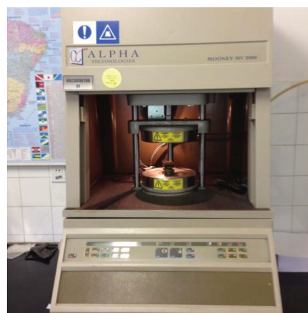
Figura 2.2. Viscosímetro Mooney computadorizado MV 2000 - ALPHA TECHNOLOGIES - utilizado para determinação da viscosidade Mooney
