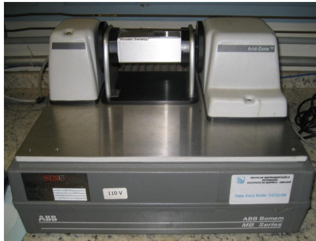
Figura 2.3. Espectrofotômetro FT-NIR-Bomem equipado com acessório Powder Samplir para medidas por reflectância difusa
