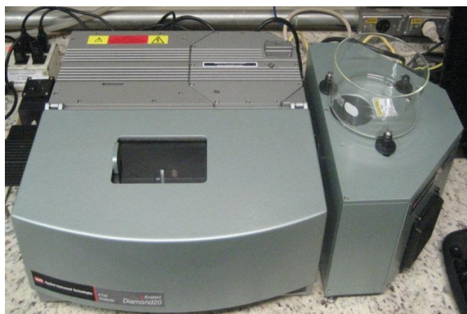
Figura 3.2. Espectrofotômetro AIT Diamond 20 (FT-NIR-AIT) acoplado com acessório de reflectância difusa
