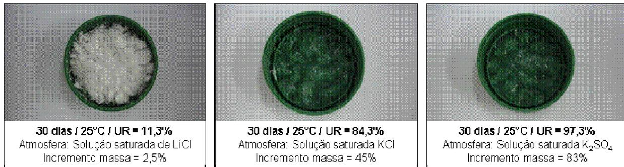
*Figura 11 – Aparência das amostras submetidas à atmosfera com umidade relativa controlada*
